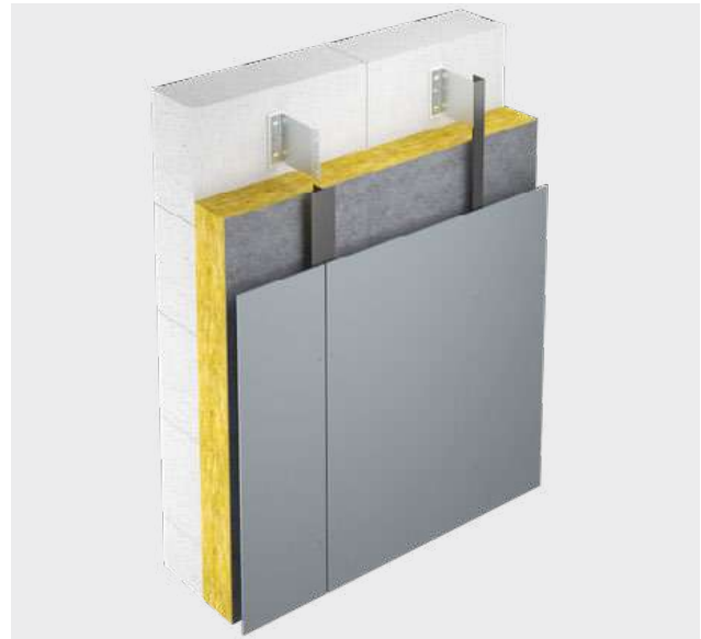
Configuration classique de montage
