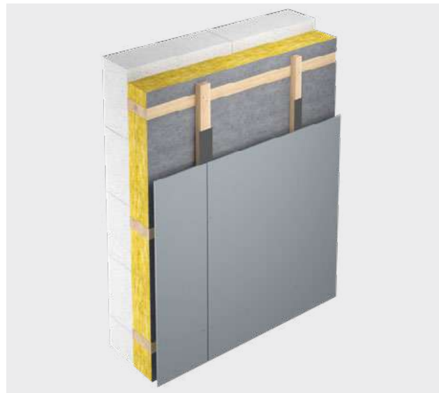
Configuration avec contre-lattage horizontal
