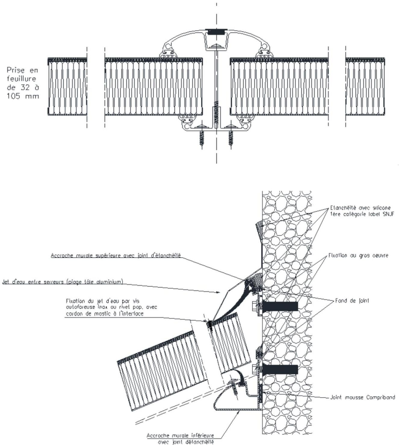
**Figure 3 – principe de pose des profilés gamme**
