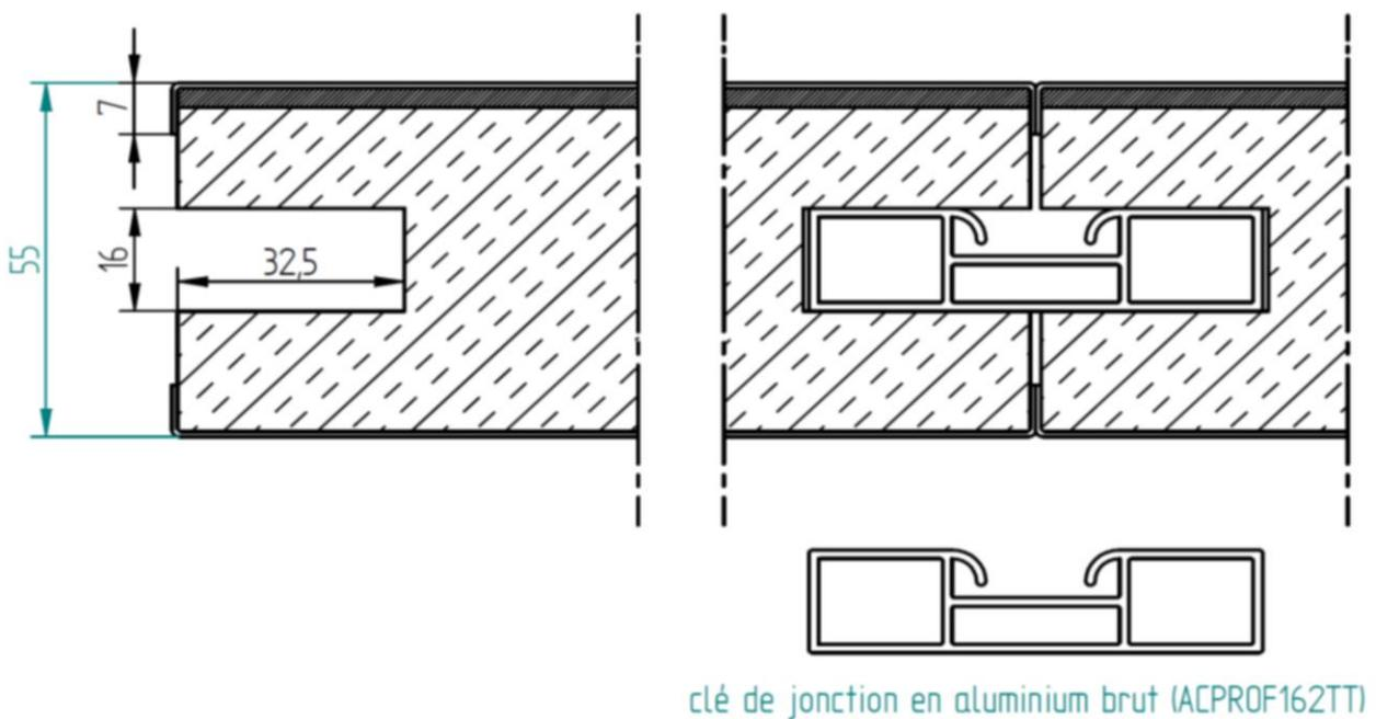
Assemblage panneaux autopostants rainurés avec clé de jonction en aluminium
