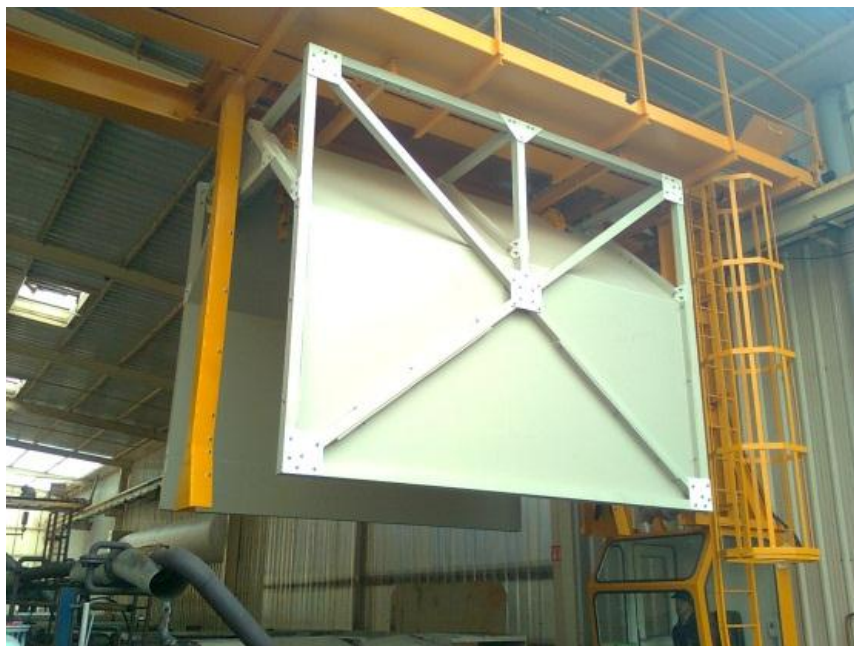
Résistance aux produits chimiques : Foamlite® est conçue sur mesure pour une utilisation dans la construction d'installations et de récipients chimiques, par exemple comme capot de recouvrement amovible dans une installation de galvanisation (photo : Europe Environnement, ASPACH LE HAUT, FRANCE, www.europe-environnement.com )
